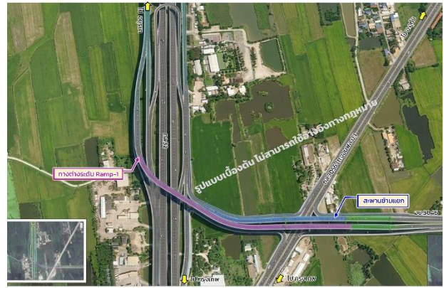
รูปที่ 8 รูปแบบทางเลือกที่ 1 สะพาน (Overpass) ข้าม ทล.3056 และทางต่างระดับเลี้ยวขวา (Directional Ramp) ข้าม ทล.32
