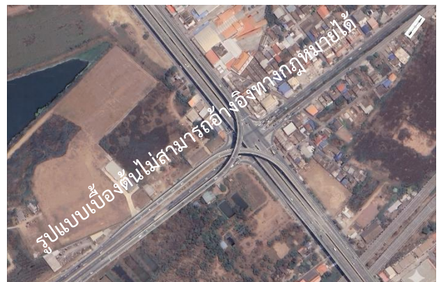
รูปที่ 6 รูปแบบทางเลือกที่ 3 สะพานข้ามแยกเลี้ยวขวา (Direction Ramp) แบบซ้อนทับ (Stacked Directional Ramp)
